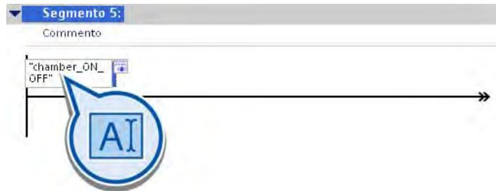
3. Inserire l'istruzione "Bobina di uscita" alla fine del montante.
