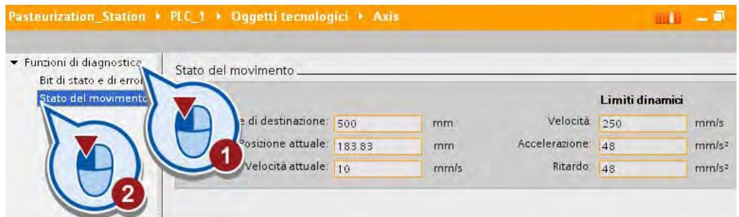
Nel campo "Posizione attuale" viene visualizzata la posizione attuale dell'asse motore. Al raggiungimento della posizione di destinazione a + 500 mm dalla posizione di inizio, l'asse si arresta.
