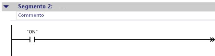
In questo modo è stata programmata la prima condizione di avvio del nastro trasportatore. Al momento dell'accensione dell'impianto la variabile "ON" viene impostata allo stato di segnale "1", il contatto normalmente aperto viene chiuso e la corrente viene trasmessa sul montante. Nella sezione seguente l'utente programmerà ulteriori condizioni che verranno eseguite in funzione dello stato di segnale della variabile "ON".
