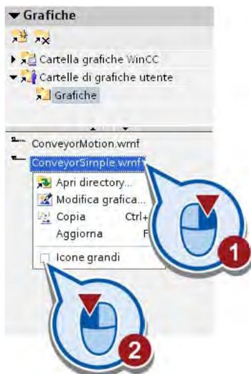
4. Trascinare l'oggetto grafico "ConveyorMotion.wmf" con il mouse sull'area dell'editor per sostituire il nastro trasportatore esistente.
