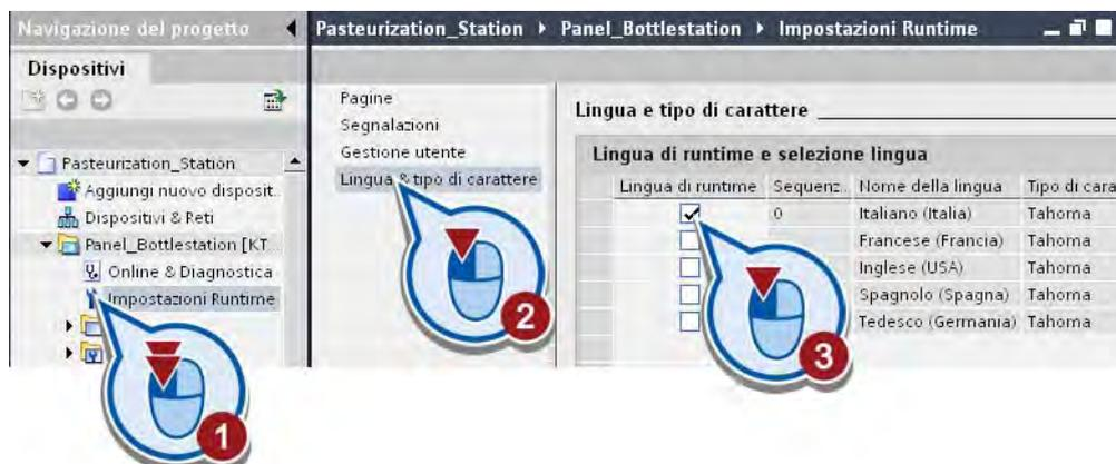
Con l'impostazione della lingua si stabilisce quali lingue caricare nel pannello operatore. Il numero di lingue che si possono caricare varia a seconda del pannello operatore utilizzato. La lingua con il numero sequenziale "0" viene visualizzata per prima all'avvio.
