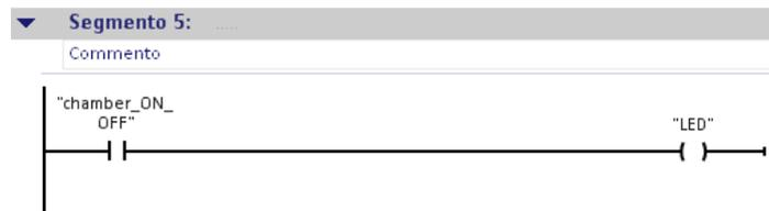
Se la camera di riscaldamento viene attivata, la variabile "chamber\_ON\_OFF" fornisce lo stato di segnale "1". Con l'istruzione "Bobina di uscita" la variabile "LED" viene impostata allo stato di segnale "1". Finché la camera di riscaldamento è attiva, la variabile "LED" fornisce lo stato di segnale "1". Quando si disattiva la camera di riscaldamento il valore delle variabili "chamber\_ON\_OFF" e "LED" passa a "0".
