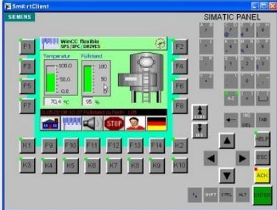
NB: se abilito lo SMART SERVER nelle impostazioni di runtime del SERVER riuscirò ad accedere al link dello Start SmartClient indicato in figura, ed effettuare il remote control del pannello.
