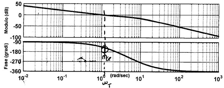
1. Si consideri il sistema in controeazione riportato in figura, in cui  $h_0 = 2$ ,  $C(s) = 10$  e  $P(s) = 0.05 \frac{1-0.5s}{s(1+0.1s)(1+0.2s)}$ . I diagrammi di Bode della funzione  $F(s) = h_0P(s)C(s)$  sono anche riportati in figura.
