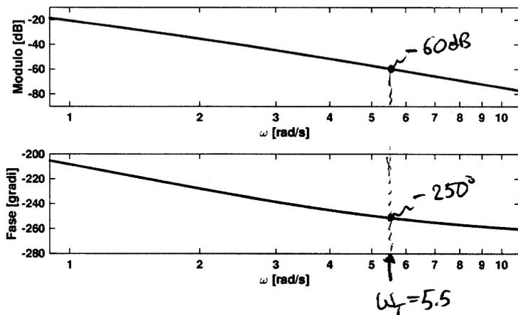
Es. 3) Dal diagramma delle fasi, per  $\omega = 5.5$ , si vede che  $\phi(\omega) \approx -250^\circ$ , mentre, per avere  $m_\phi$  di  $40^\circ$ , dovrebbe valere  $-140^\circ$ . Occorre allora le fasi di  $110^\circ$ .
