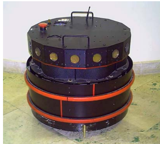
fig.2 Robot mobile Nomad 150 : 16 sensori ad ultrasuoni per il rilevamento di ostacoli + 20 sensori di pressione (contatto) + 3 sensori odometrici (un encoder per ruota)
