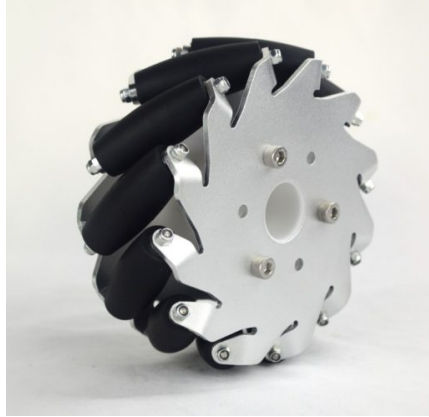
Figura 3.3: ruota mecanum con l'asse dei rulli posti a 45 gradi rispetto all'asse di rotazione dell'intera ruota.
