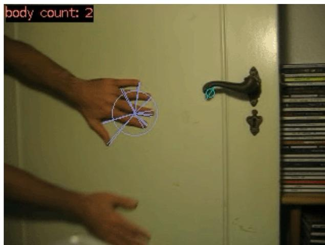
*Fig. 76: In questo fotogramma vengono rilevati due corpi, uno dei quali esiste per soli 3 frame in corrispondenza della maniglia della porta.*
