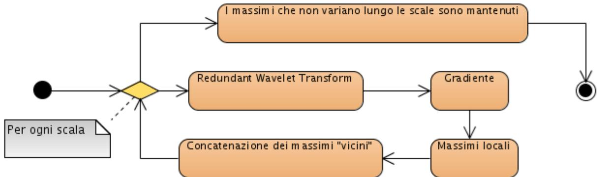
Fig. 41: Diagramma di flusso del metodo WMC
