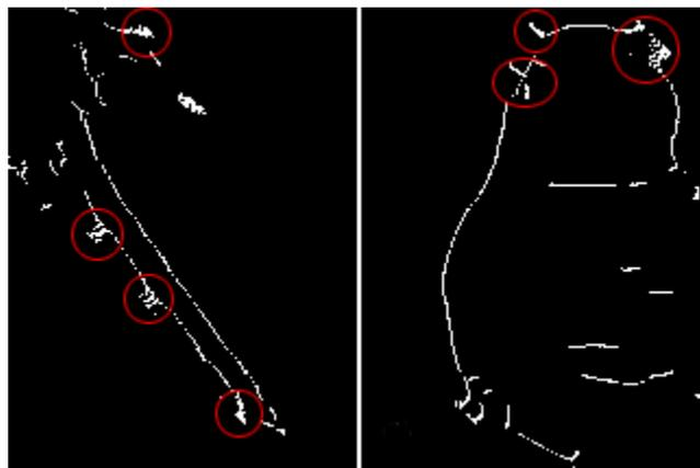
*Fig. 99: La mappa ottenuta dal rilevatore in multirisoluzione è sensibile al rumore in prossimità di bordi spezzati*
