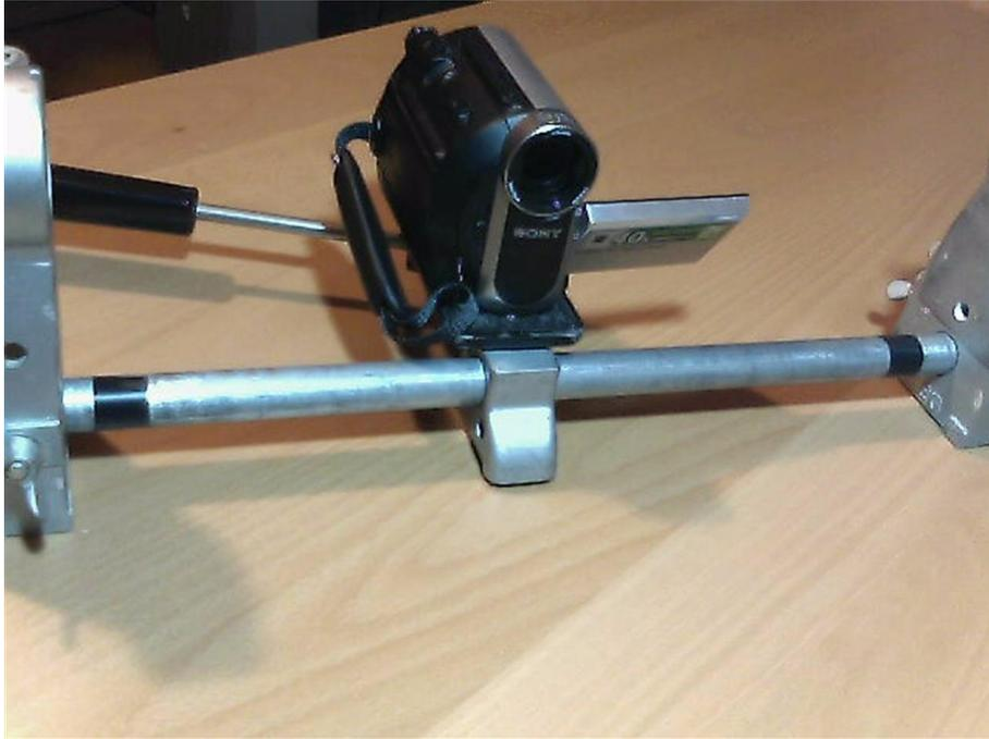
Figura 1.1: Telecamera e guida utilizzate nella realizzazione del sistema di visione.
