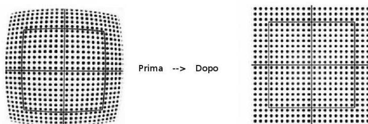
Figura 6.19: Correzione della distorsione radiale
