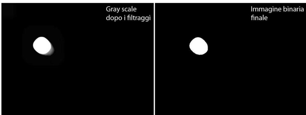
Figura 3.6: L'immagine grayscale viene trasformata in binaria
