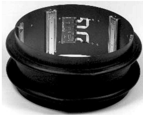
Figura 2.3: I bumper nel robot Nomad 150
