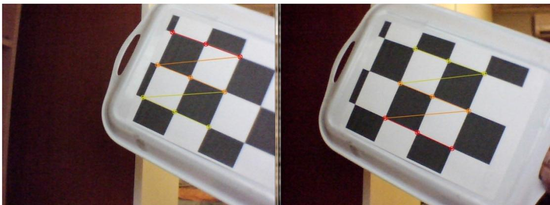
*Illustrazione 38: Rilevazione errata dovuta ad un inserimento non corretto dei parametri*
