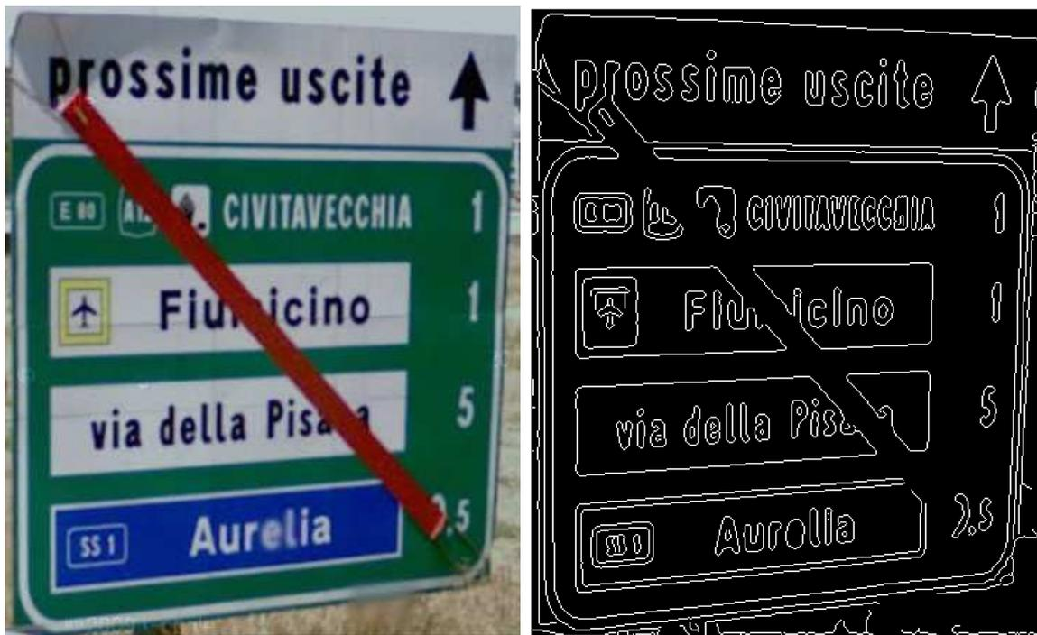
Un problema fondamentale nella visione artificiale riguarda il riconoscimento di oggetti noti, essendo questa la base per ogni processamento di immagini partendo dalla semplice taratura del sensore fino alle più avanzate tecniche di videosorveglianza o guida automatica di veicoli. Le numerose tecniche sviluppate negli anni attingono da delle operazioni basiche di segmentazione, ossia di separazione di regioni nell'immagine
