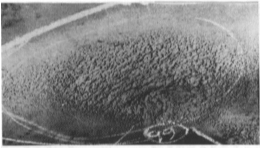
Figura 1.12: Usura della superficie di pala di un'elica navale prodotta dal fenomeno della cavitazione.
