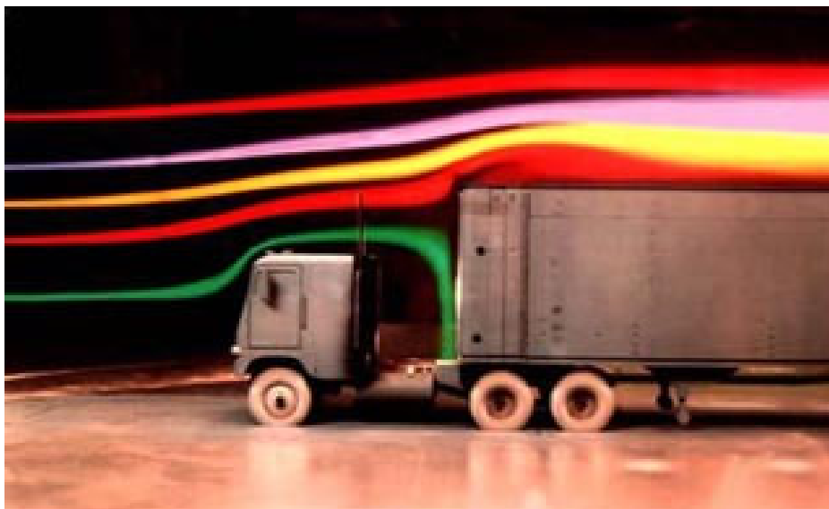
Figura 3.4: Esempio di streaklines intorno ad un modello di camion in un tunnel ad acqua.
