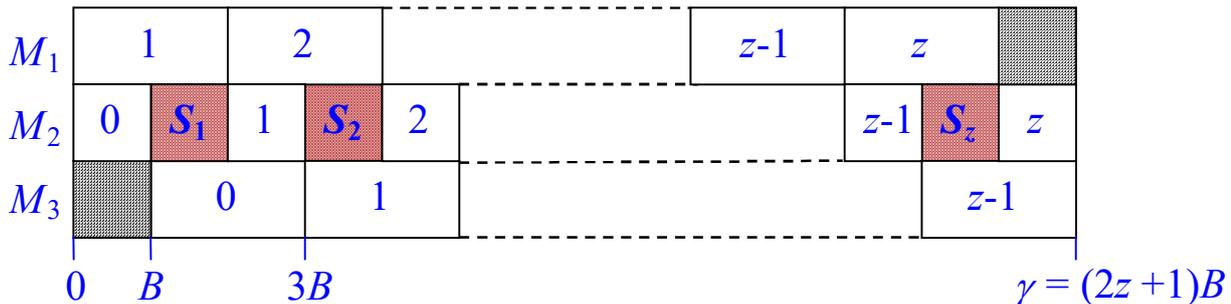
**N.B.:**  $C_{\max}^* = \gamma$  se i primi  $z+1$  job sono schedulati secondo l'ordine  $0, 1, \dots, z$  lasciando  $z$  intervalli disgiunti su  $M_2$  ciascuno lungo  $B$  dove poter schedulare i job  $\{z+1, \dots, 4z\}$ .
